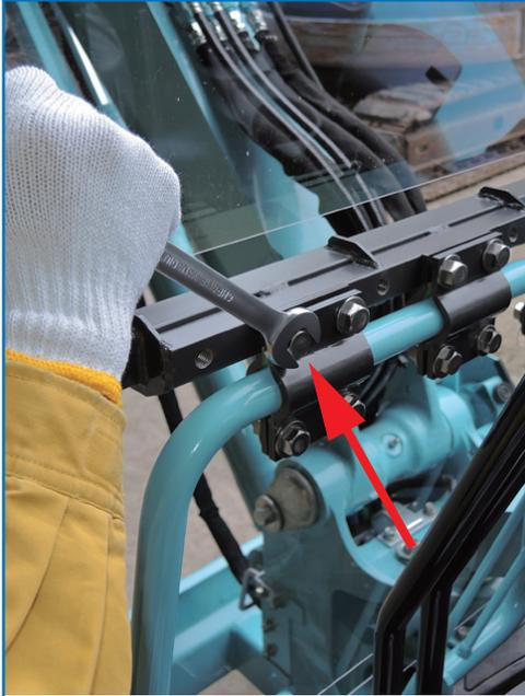
【1】着脱の際は本体H型フレームを、同梱のクリップと17mmスパナ等で行います。取付けの際はしっかりと締め付けて下さい。
